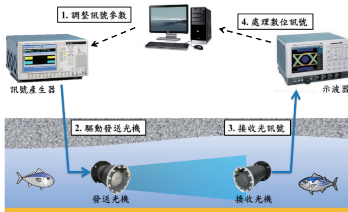
圖 11 工研院水下可見光通訊通道量測架構
