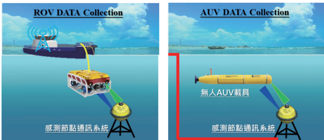
圖 7 Sonardyne 的 BlueComm 水下無線光傳輸系統使用情境
