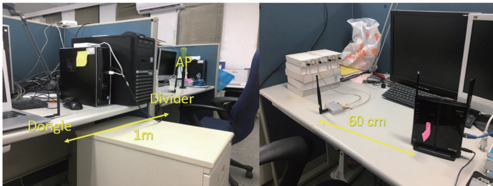
圖 38 Rayleigh 通道實際量測接線
